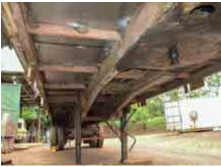
Abb. 4: Der Boden des großen Anhängers, der alljährlich für die Umsiedlung von vielen Huftieren verwendet wird, nach dem Einschweißen von Edelstahlplatten. Floor of the large game-capture trailer of BGP after stainless steel plates were welded in. This trailer is used multiple times a year for moving various hooved game animals. (Foto: A. Sliwa)
