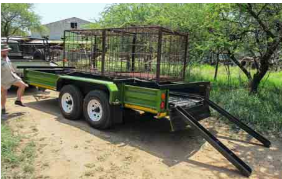
Abb. 3: Geländegängiger Anhänger für den Transport von Fallen für die Umsiedlung von Nilkrokodilen und Flusspferden, der durch den Kölner Zoo gesponsort wurde. Versatile off-road trailer designed for the recovery of captured hippos and crocodiles as well as a set of crocodile traps, sponsored by Cologne Zoo. (Foto: A. Sliwa)
