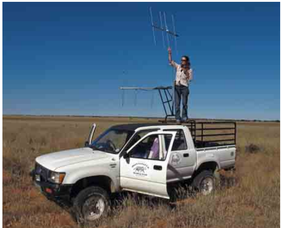
Abb. 16: Martina Küsters versucht von einem hohen Standpunkt die größtmögliche Empfangsdistanz des Signals der angelegten Radiohalsbänder zu erzielen. Martina Küsters is trying to obtain the maximal reception distance of the fitted radio-collars, by climbing the highest point of the vehicle.
