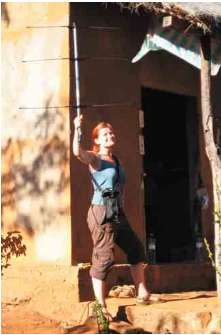
Abb. 21: Mit Hilfe der Antenne und des Empfängers wird das Signal der Radiohalsbänder empfangen.
